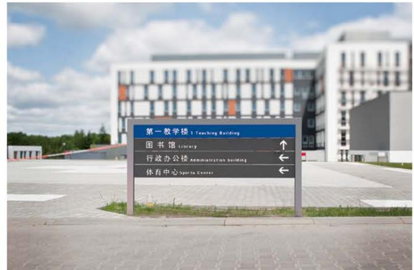
矮版室外导视牌，主要用于不适合高指示牌的区域和位置，例如楼前窗户下、路中央绿化带等。导视牌用颜色标示所处位置，其余方位增加箭头，可单面或双面进行丝网印刷，每块指示牌独立安装。边框采用铝合金架构，中间镂空，设置轨道以及固定卡扣，方便导视内容的安装和更换。
