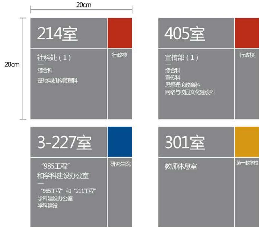
左侧指示牌主要用于楼道内悬挂，用来指示房间方向位置。指示牌用色块区分所在区域功能。制作工艺采用金属丝网印刷，或硬塑料材质印刷，使用金属挂杆悬挂。每块独立制作箱体，用挂杆连接。
