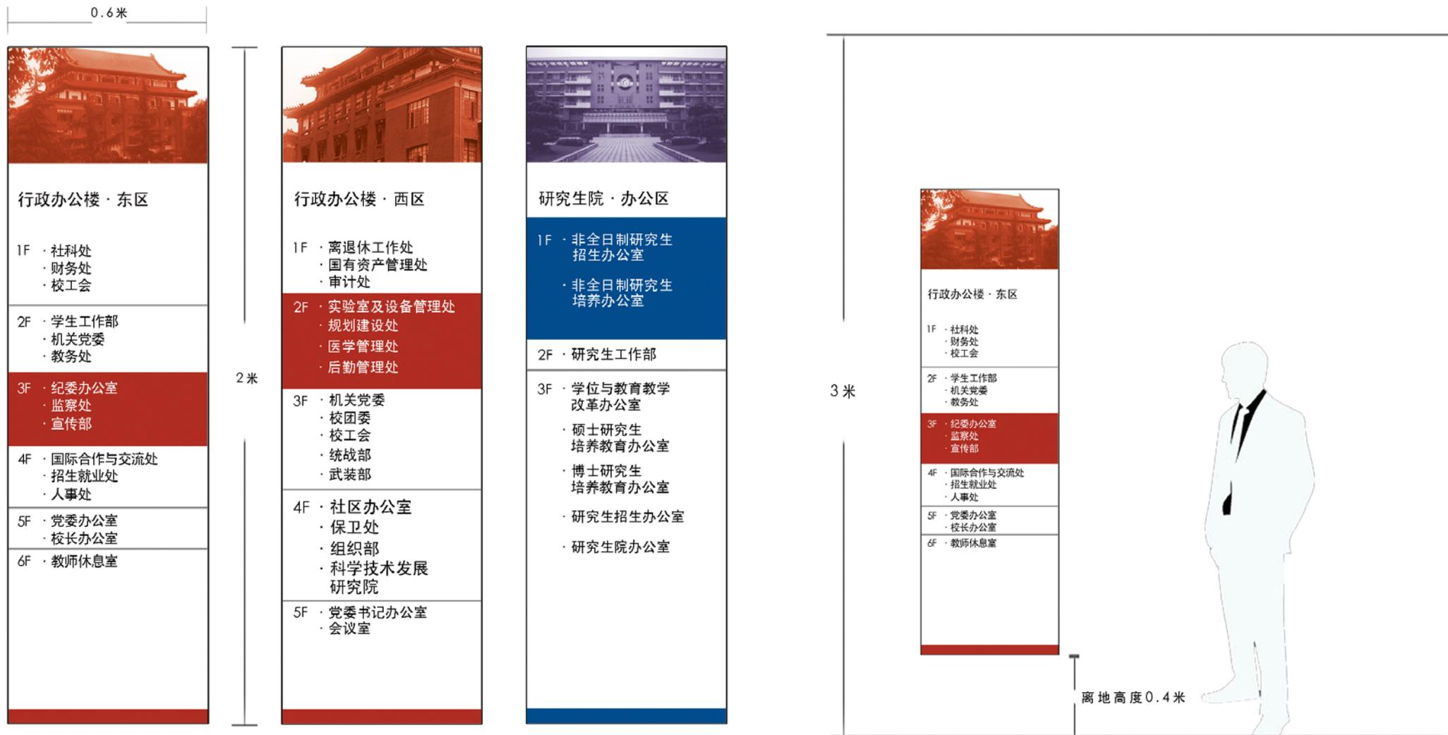
该导视牌主要用于楼内楼层单位指示，可悬挂于楼梯口、走廊墙壁等位置。导视牌用四种标识色区分建筑功能，红色为办公系统建筑，蓝色为教学系统建筑，黄色为综合性功能建筑，绿色为综合系统建筑，上部都采用具有代表性的建筑照片，进行单色处理，与整体色调相符合。材料使用不锈钢板材，丝网印刷。所在楼层用色块标出。导视牌构造为多层套叠，方便进行更换和维修，如有调整，只需更换调整区域板块即可。
